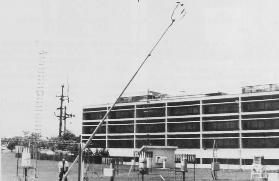
Une nouvelle tour pliable permet d'abaisser l'instrument au sol.
