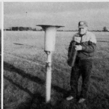
M. Chirka tient aussi une station climatique dans la ferme. Le voici avec un nivomètre à écran de Nipher, recueillant la neige qu'on fait fondre et qu'on mesure dans un tube gradué.
