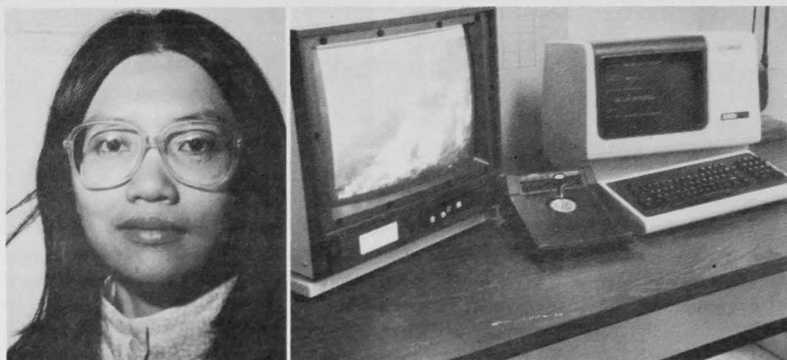
Depuis trois ans, TSOI-CHING YIP travaille avec le processeur du sondeur vertical opérationnel TIROS-N à la section de météorologie aérospatiale, au SEA, à Downsview. Elle est chargée des programmes de logiciel utilisés pour obtenir des données météorologiques spéciales sur la haute atmosphère à partir des six orbites quotidiennes du satellite qui tourne autour du pôle à 870 km d'altitude.
