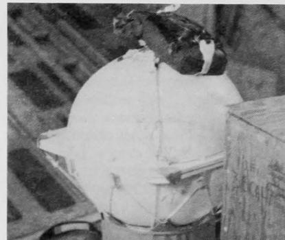
*Bouée tout équipée avant son mouillage dans la banquise Arctique. Les instruments comprennent notamment un baromètre anéroïde, un capteur de température, un circuit logique de synchronisation et un petit émetteur radio alimenté par une pile au lithium.*
