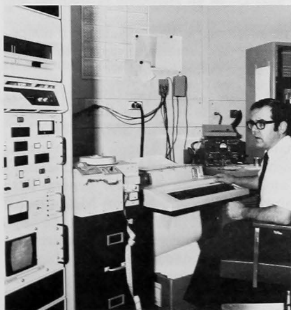
L'auteur, Ken Devine, étudie le système ADRES, y compris le mini-ordinateur, le lecteur-perforateur de rubans de papier, le terminal à imprimante et le châssis pour le matériel qui, tous, équipent les stations aérologiques de façon normale. (Applied Photo)
