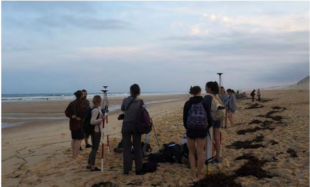
Atelier de mesure topographique du profil de plage grâce à des positionnements par GPS différentiels. Photo : © Camille Brice
